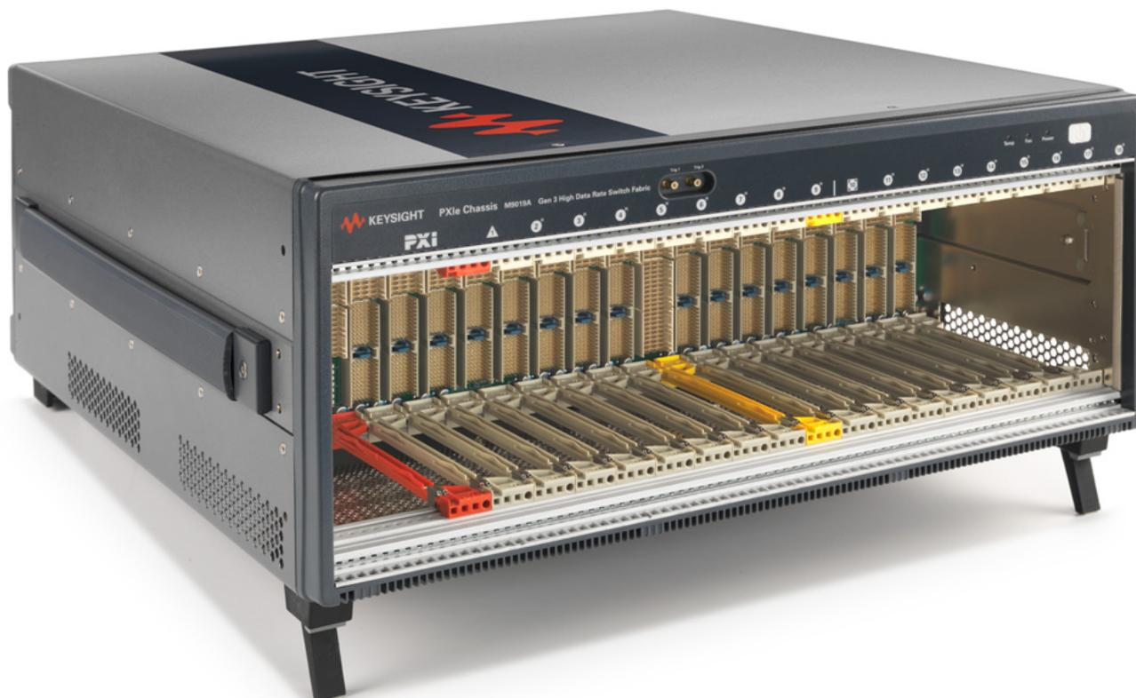
Keysight M9019A PXIe 18スロットGen 3シャーシは、要求の厳しいアプリケーションに必要な柔軟性、互換性、性能を備えています。16個のPXIeハイブリッドスロットを備え、PXIeモジュールとハイブリッド互換モジュールを混在して搭載できます。超高性能のPCIe®スイッチファブリックは、最高Gen 3の速度で動作し、最大24 GB/sのシステムデータ帯域幅を備えています。
